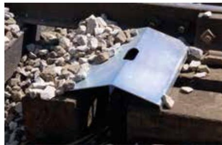
Quatre protections de ballast pour protéger les cylindres de levage.
